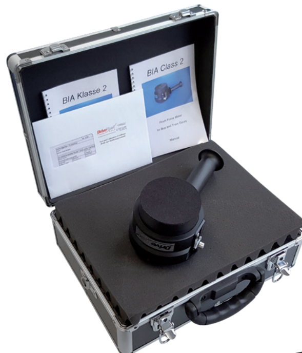
Sofortige Auswertung anhand des Schleppzeigers, der den Spitzenwert der Kraft anzeigt.
