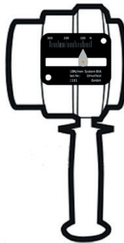
Sofortige Auswertung anhand des Schleppzeigers, der den Spitzenwert der Kraft anzeigt.
